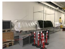
Bepflanzter Windkanal Quelle: HANZA Tech Solutions GmbH
